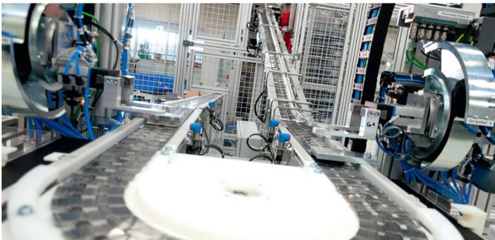
Handlingssystem für Flanschringe inkl. Werkstückprüfung
